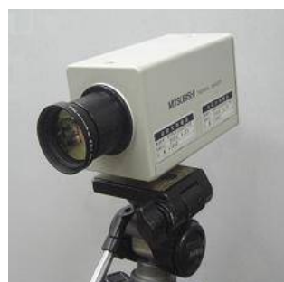
図 1 「三菱サーマルイメージャ(IR-SC1)」 三菱電機株式会社製
