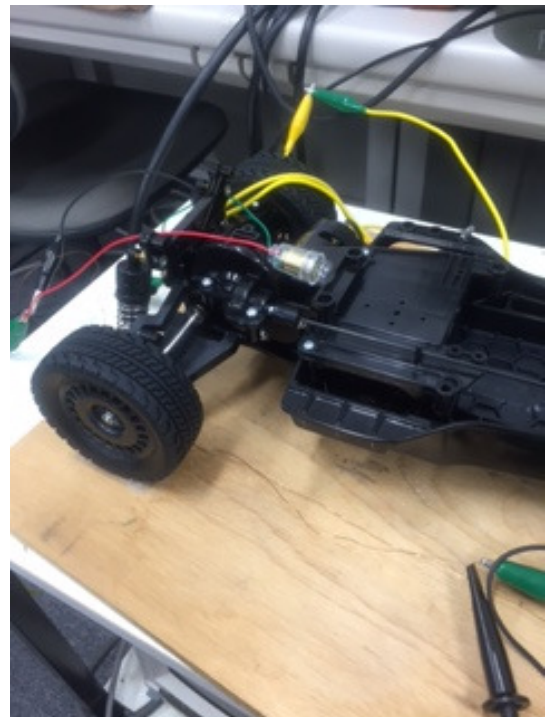
図 12 電力が伝送されず負荷電球が消灯している状態
