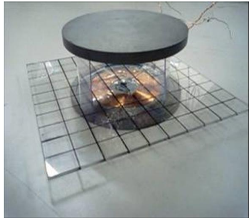
図3 スプ型フェライトを使用した一次・二次コア分離型单相変圧器
