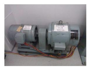
図5 誘導電動機及び直流発電機
