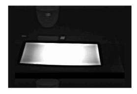
(f)180 秒 図 14 IH 調理器による鉄の加熱赤外線画像
