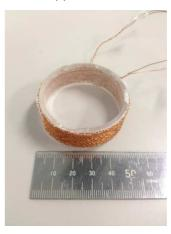
(c) タイプ C図 7 試作ツイストコイル型空心変圧器
